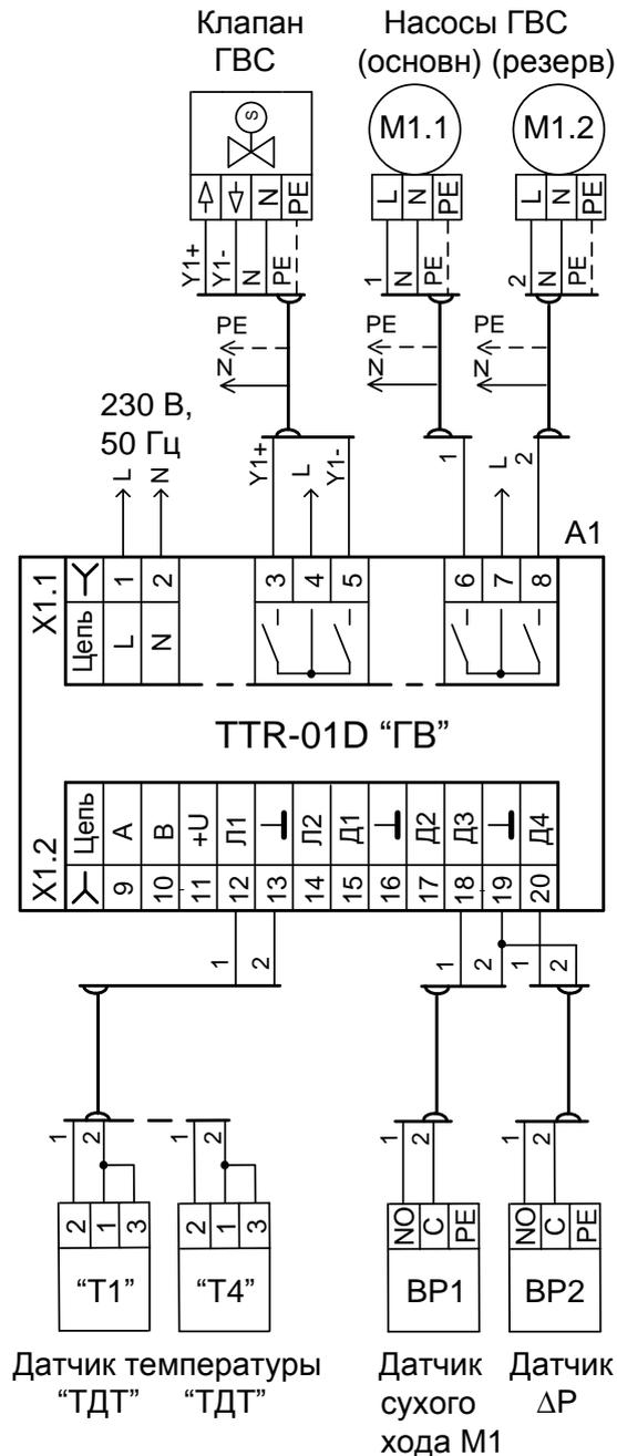
**Пример применения:** TTR поддерживает в системе ГВС заданную температуру горячей воды Т1. Для защиты работы насоса от сухого хода подключается датчик BP1. При неисправности в работе насоса по датчику BP2 производится ввод в работу резервного насоса.
