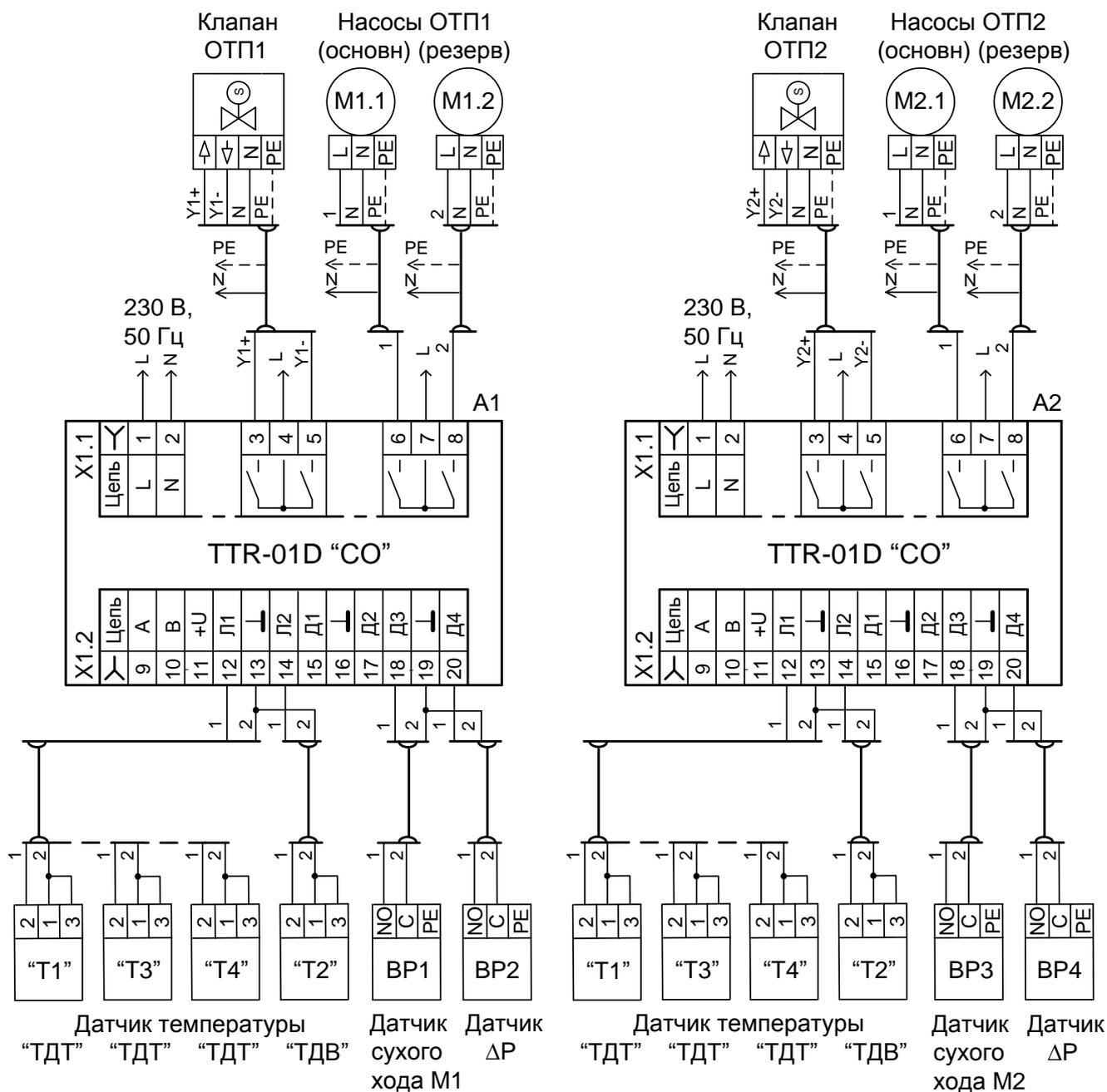
**Пример применения:** В каждом контуре отопления A1 и A2 поддерживают температурный график теплоносителя  $T1=f(T2)$ . Для защиты работы насосов от сухого хода в каждом контуре подключаются соответственно датчики BP1 и BP3. При неисправности в работе насоса по датчикам BP2 и BP4 соответственно для контура отопления 1 и 2 производится ввод в работу резервного насоса.
