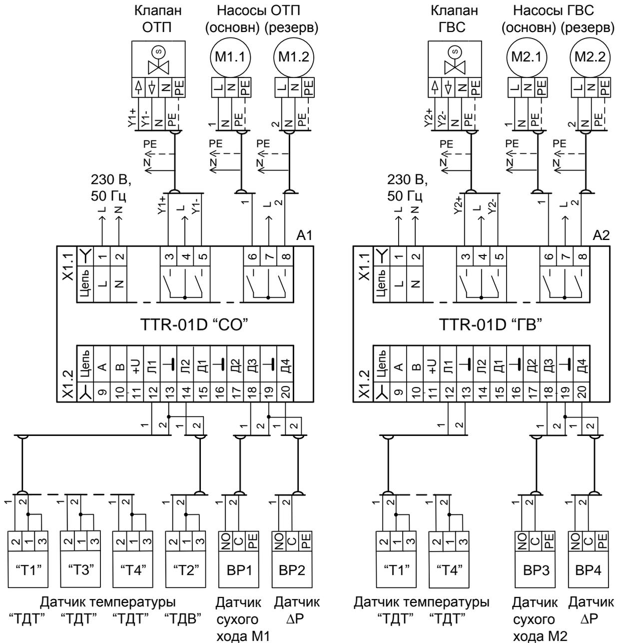
**Пример применения:** В контуре отопления A1 поддерживают температурный график теплоносителя  $T1=f(T2)$ . Для защиты работы насосов от сухого хода в контуре подключается датчик BP1. При неисправности в работе насоса по датчику BP2 производится ввод в работу резервного насоса.
