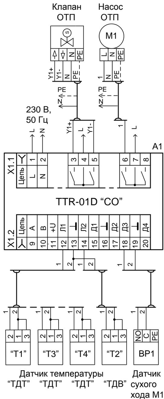
**Пример применения:** TTR поддерживает в системе отопления температурный график теплоносителя  $T1=f(T2)$ . Для защиты работы насоса от сухого хода подключается датчик BP1.
