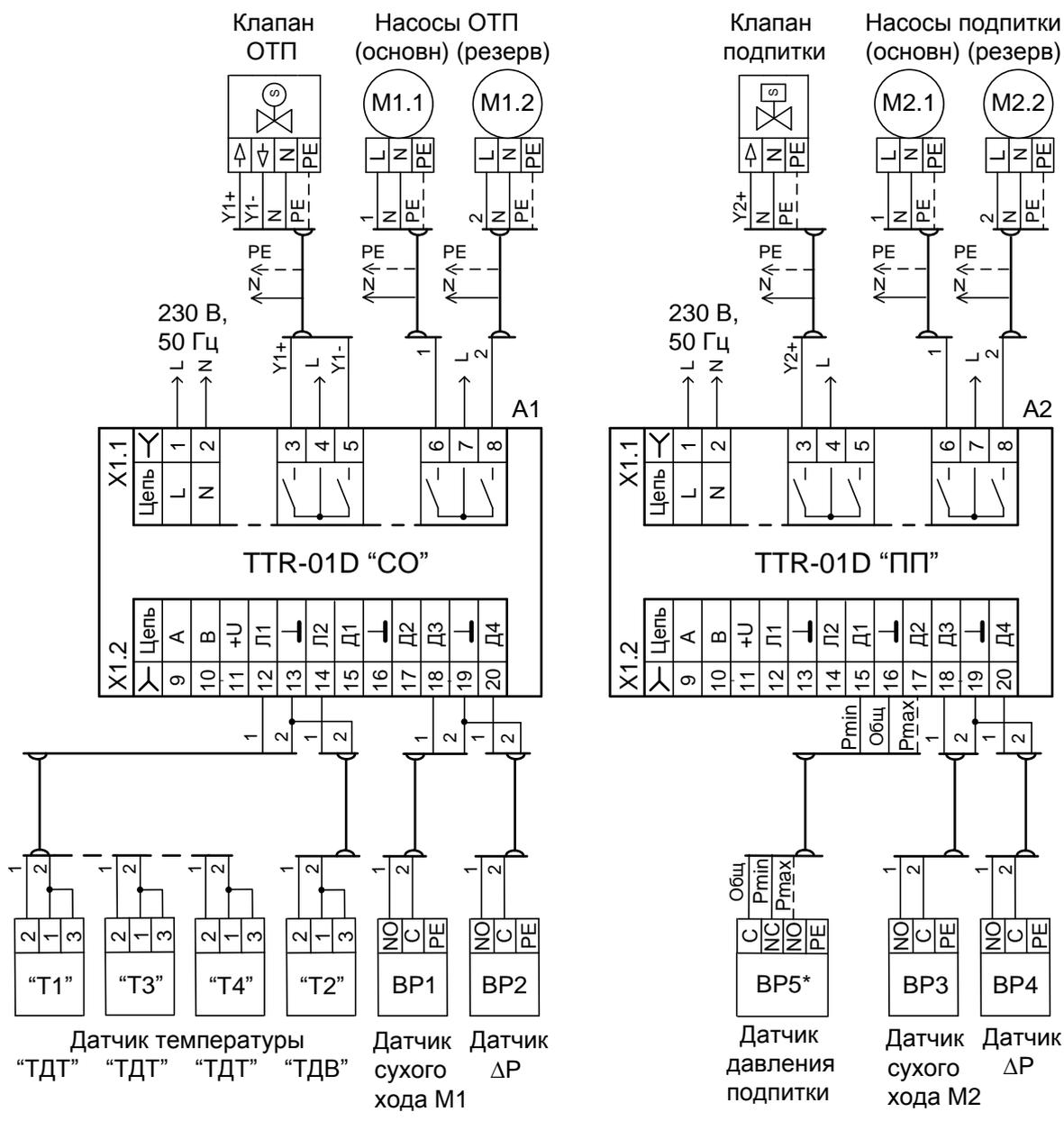
**Примечание** - \* Для датчика подпитки типа "ДР-Д" цепь подключения "Pmax" отсутствует.
