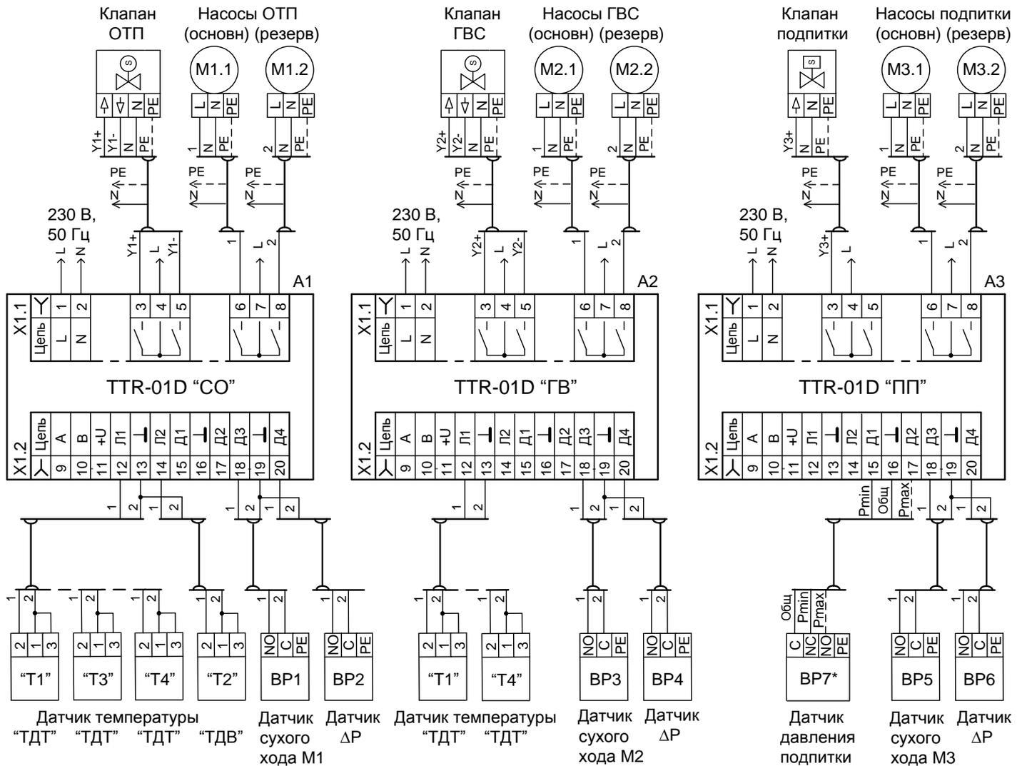
**Примечание - \*** Для датчика подпитки типа “ДР-Д” цепь подключения “Pmax” отсутствует.
