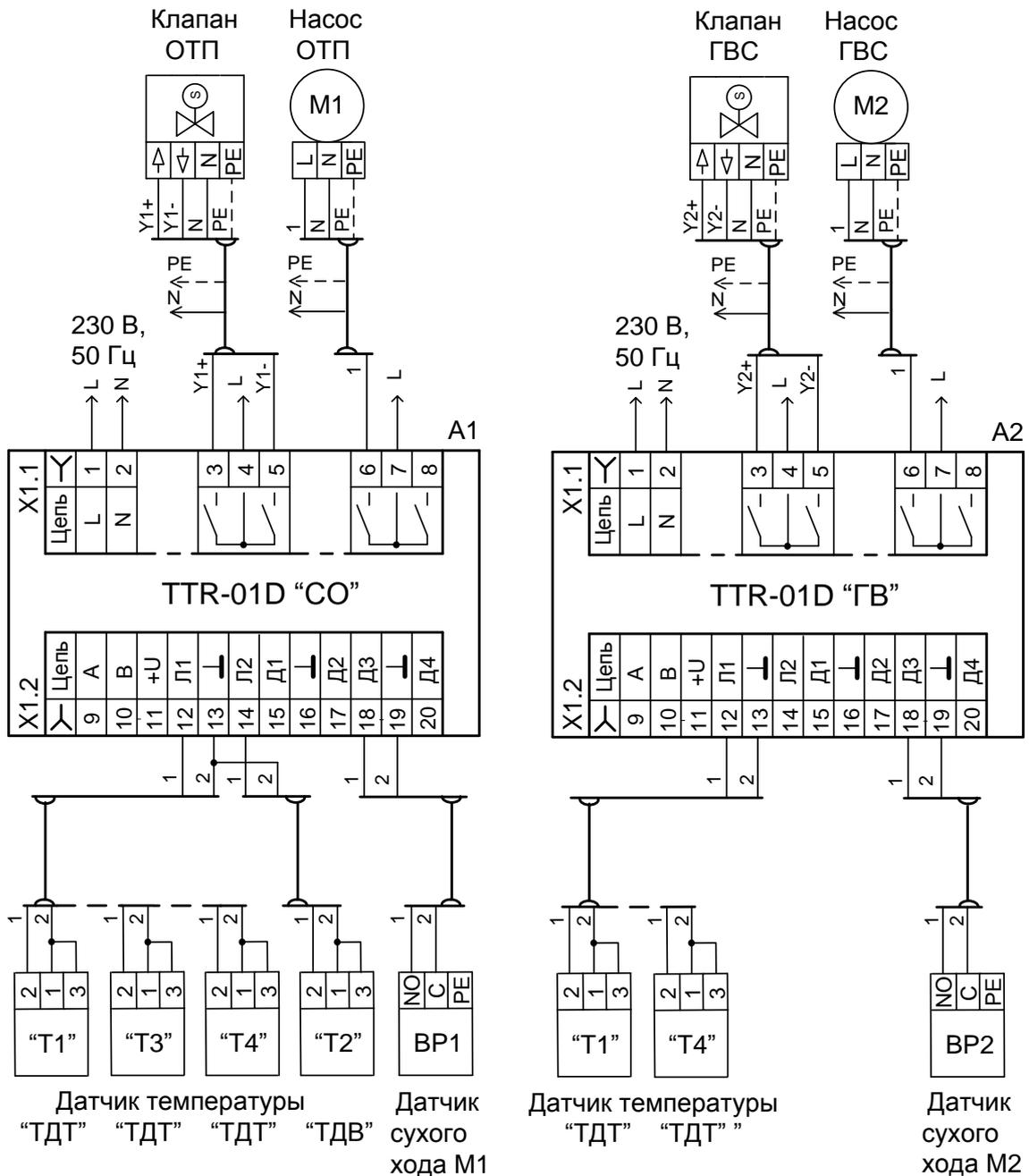
**Пример применения:** В контуре отопления A1 поддерживает температурный график теплоносителя  $T1=f(T2)$ . Для защиты работы насоса M1 от сухого хода подключается датчик BP1.
