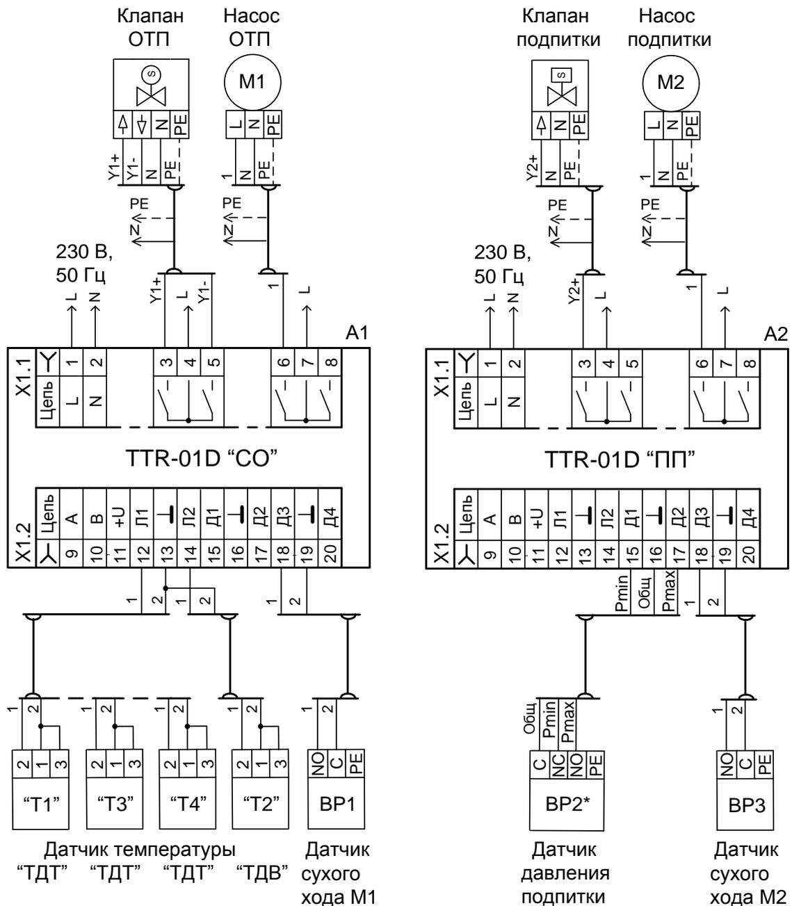
**Примечание** - \* Для датчика подпитки типа “ДР-Д” цепь подключения “Pmax” отсутствует.
