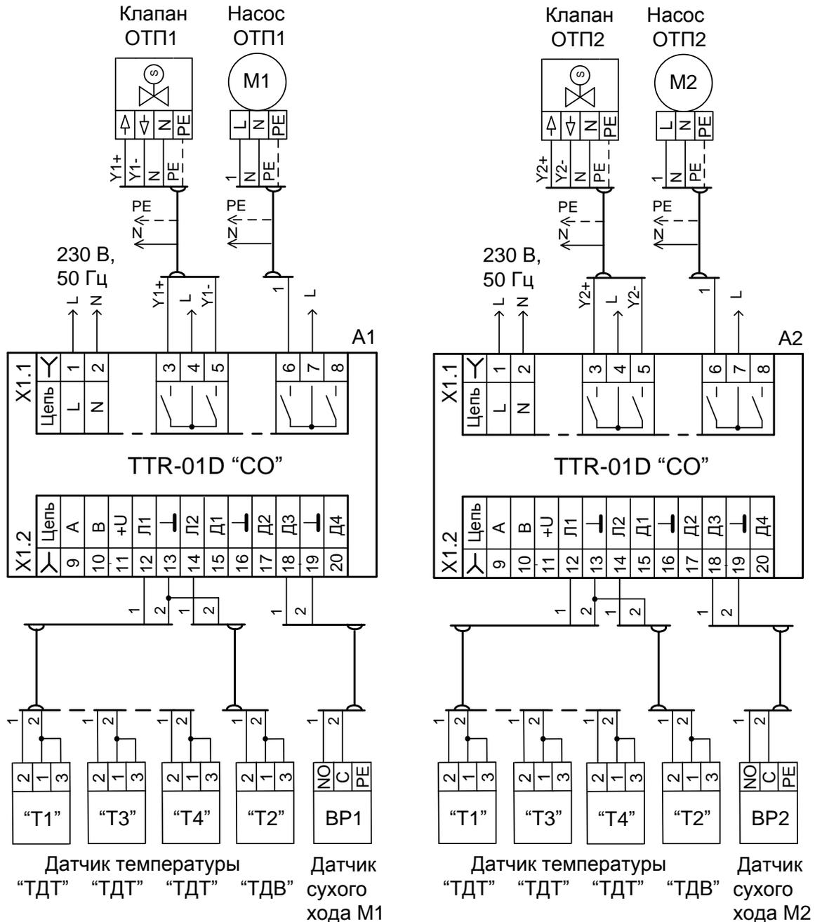
**Пример применения:** В каждом контуре отопления A1 и A2 поддерживают температурный график теплоносителя  $T1=f(T2)$ . Для защиты работы насосов от сухого хода подключаются датчики BP1 и BP2 соответственно для насоса контура отопления 1 и 2.
