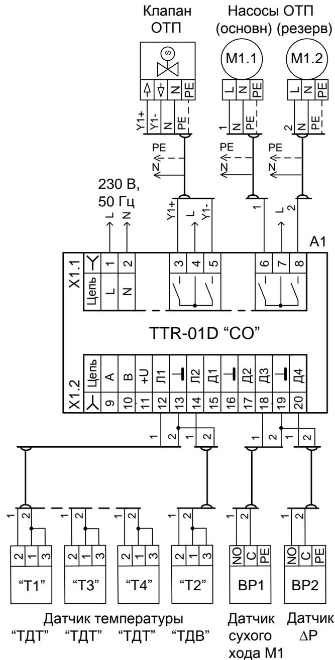
**Пример применения:** TTR поддерживает в системе отопления температурный график теплоносителя  $T1=f(T2)$ . Для защиты работы насосов от сухого хода подключается датчик BP1. При неисправности в работе насоса по датчику BP2 производится ввод в работу резервного насоса.
