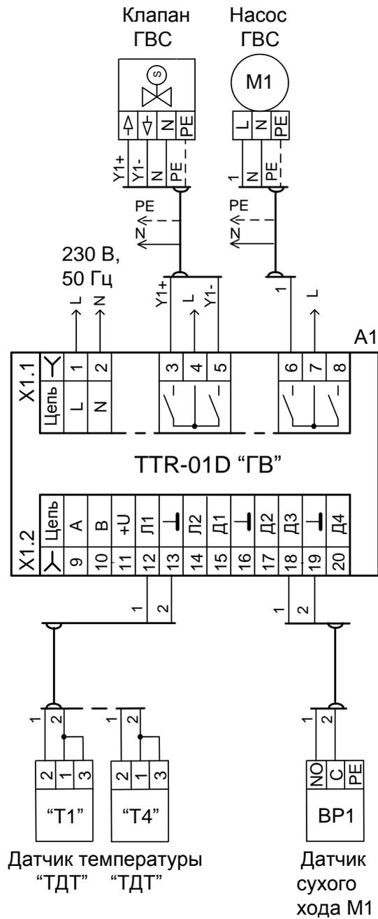
**Пример применения:** ТТR поддерживает в системе ГВС заданную температуру горячей воды Т1. Для защиты работы насоса от сухого хода подключается датчик ВР1.
