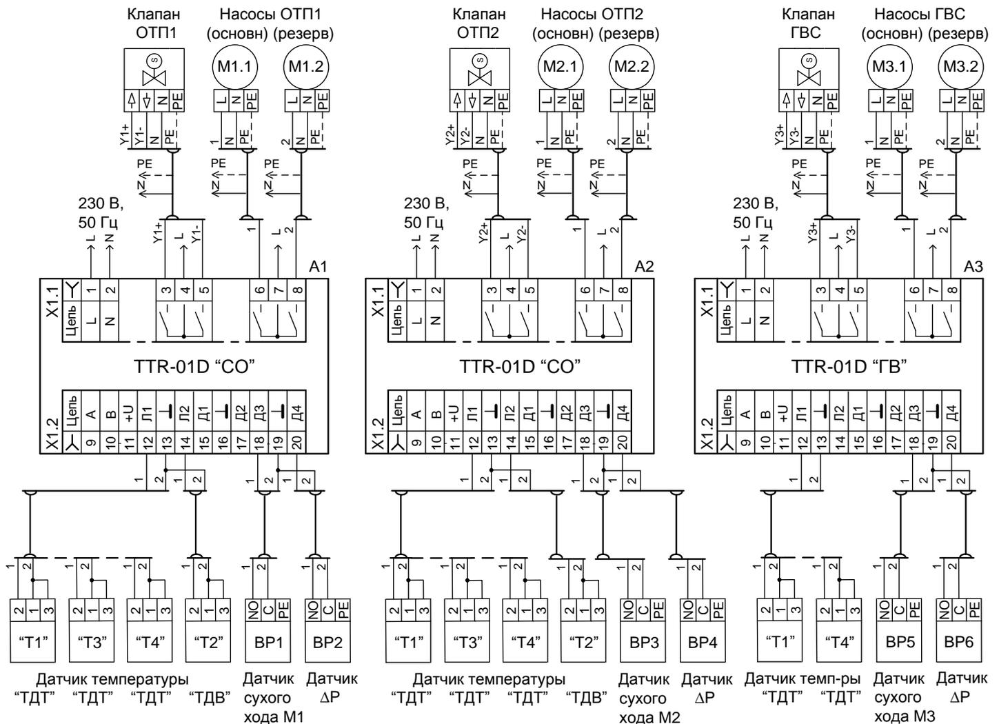
**Пример применения:** В каждом контуре отопления A1 и A2 поддерживают температурный график теплоносителя  $T1=f(T2)$ . Для защиты работы насосов от сухого хода в каждом контуре подключаются соответственно датчики BP1 и BP3. При неисправности в работе насоса по датчикам BP2 и BP4 соответственно для контура отопления 1 и 2 производится ввод в работу резервного насоса.
